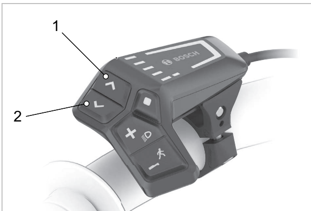
Abbildung 206: Lage Helligkeit erhöhen-Taste (2) und Helligkeit vermindern-Taste (1)
