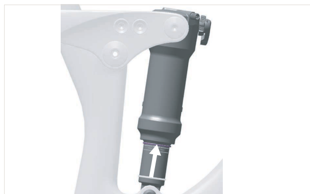
Abbildung 162: O-Ring am Hinterbau-Dämpfer verschieben
