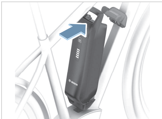
Abbildung 187: PowerPack Akku nach oben klappen
