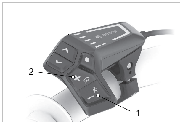
Abbildung 208: Lage Plus-Taster und Minus-Taster
