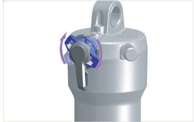
Abbildung 199: Druckstufen-Einsteller härter einstellen
