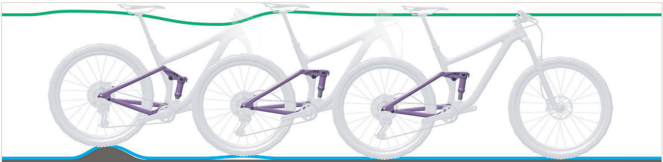
Abbildung 274: Zu schnelles Ausfedern des Hinterbau-Dämpfers
