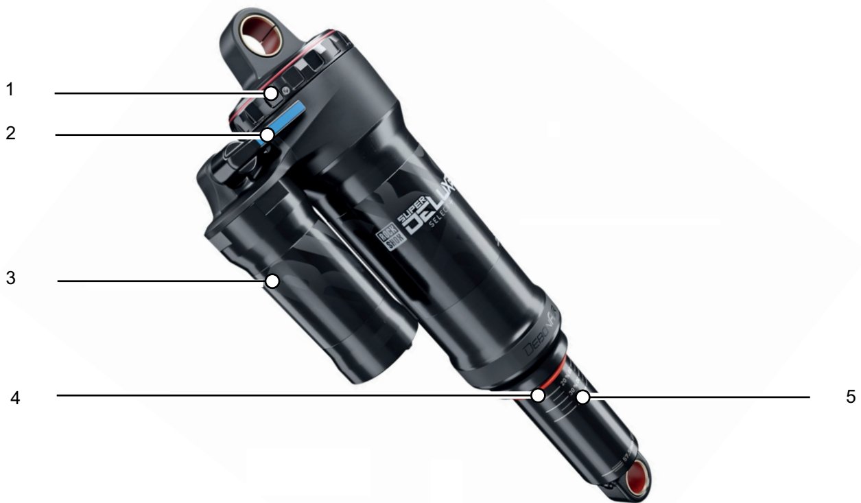
Abbildung 10: Aufbau ROCKSHOX Super Deluxe Select+ Hinterbau-Dämpfer
