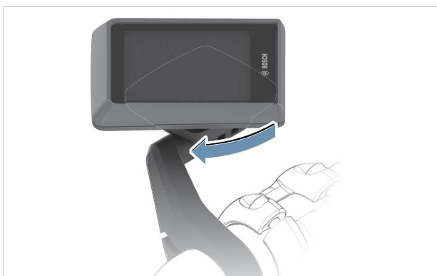
Abbildung 178: Bildschirm im Uhrzeigersinn drehen
