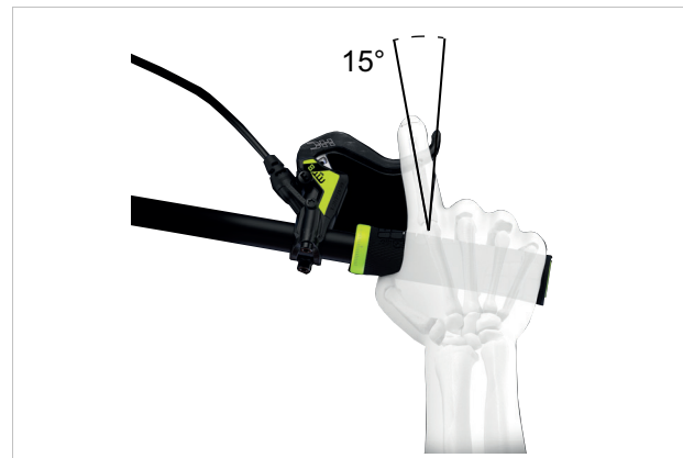
Abbildung 141: Position der Handbremse
