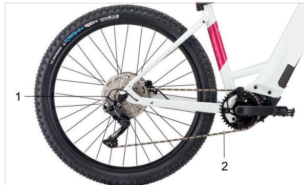
Abbildung 56: Schema Kettenantrieb mit Kettenschaltung
