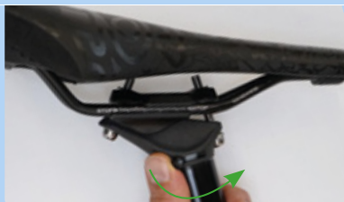
Illustration 186 : Ouvrir le réglage de la hauteur
