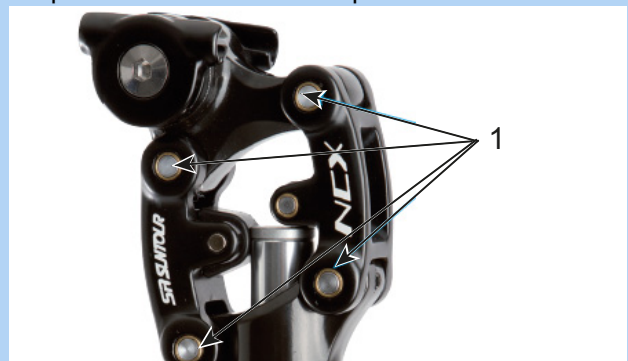
Illustration 134 : Points de lubrification de la tige de selle suspendue SR Suntour
