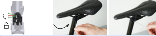
Illustration 135 : Placer le mécanisme de réglage de la hauteur en « position ouverte »
