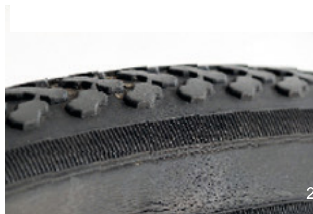
Illustration 123 : Exemples de fissures de fatigue (1) et de fissures d'âge (2)
