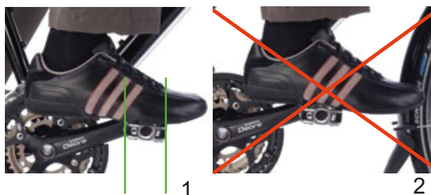
Illustration 99 : Position du pied sur la pédale, correcte (1) et incorrecte (2)
