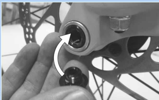
Illustration 43 : Enfoncez le levier d'attache rapide dans l'axe
