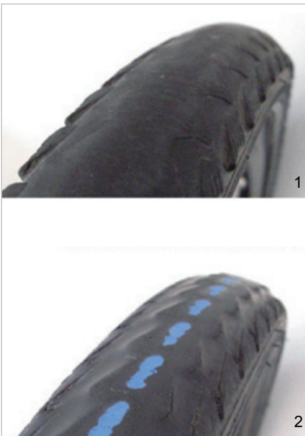
Abbildung 171: Reifen ohne Profil, der gewechselt werden kann (1) und Reifen mit durchscheinendem Pannenschutz (2), der gewechselt werden muss
