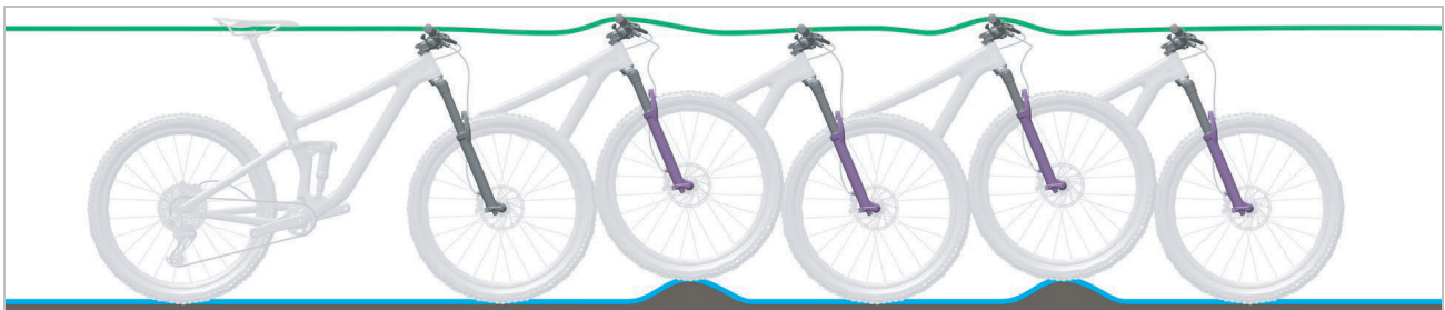
Abbildung 16: Optimales Fahrverhalten der Federgabel
