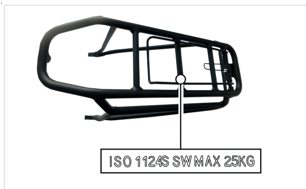
Abbildung 147: Auf dem Gepäckträger ist seine maximale Tragfähigkeit ausgewiesen
