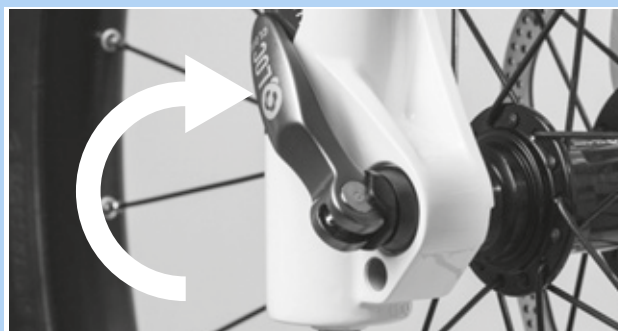
Figura 79: Cierre del cierre rápido
