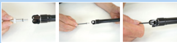
Figura 178: Fijación la tapa de la válvula del cartucho
