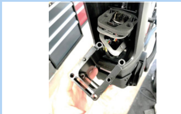
Figura 56: Extracción del adaptador PowerTube
