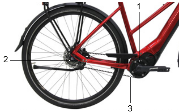
Figura 30: Esquema de la transmisión por correa
