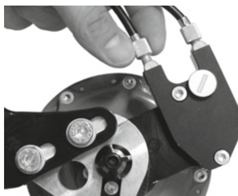
Figura 152: Las versiones de bujes Rohloff con activación de cambio externa tienen los dispositivos de ajuste de tensión en la caja de cables que se encuentra en el lado izquierdo
