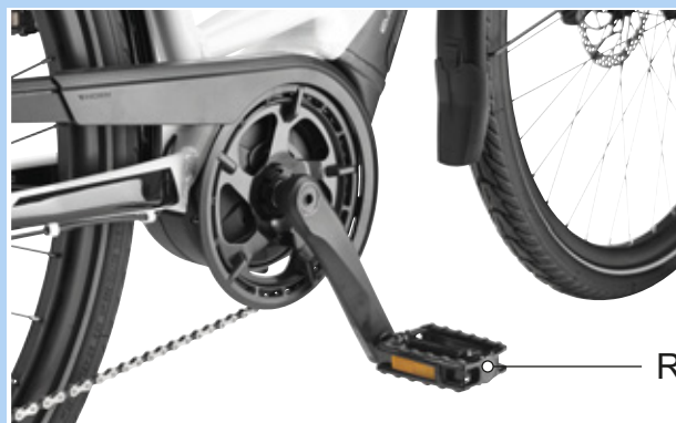
Figura 84: Pedal R en el brazo de manivela derecho
