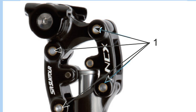
Figura 158: Puntos de lubricación de la tija de sillín de muelle SR Suntour
