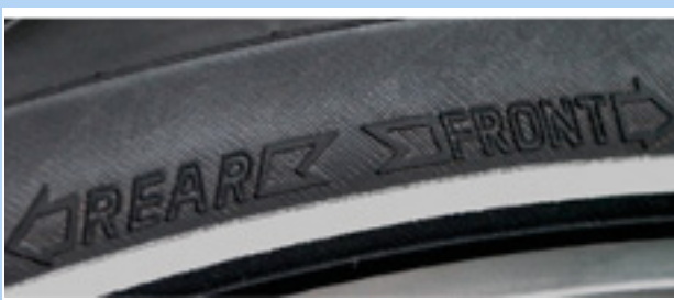
Figura 81: Flecha de sentido de la marcha en cubiertas de MTB
