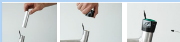
Figura 183: Montaje del casquillo deslizante y del manguito exterior
