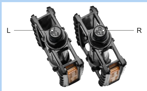
Figura 82: Ejemplo de identificación de los pedales
