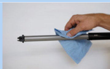
Figura 212: Limpieza de la ranura de guía longitudinal
