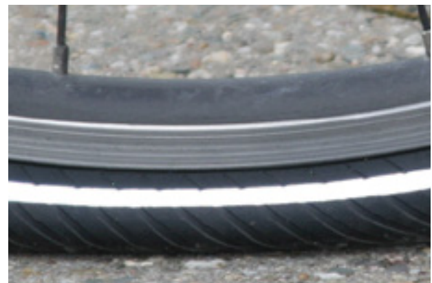
Figura 104: Presión de inflado demasiado baja
