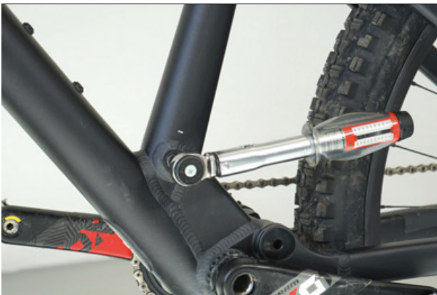
Figura 87: Apriete del eje de la tija de sillín
