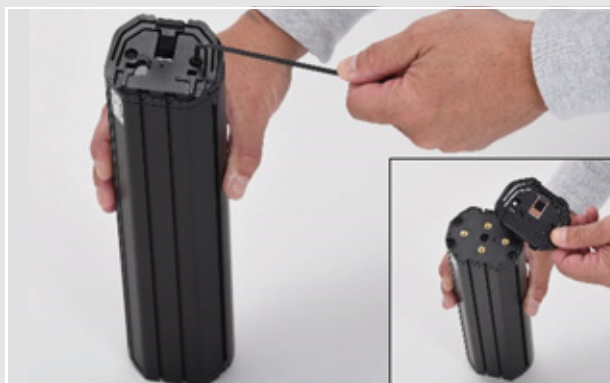
Figura 41: Desmontaje de la interfaz superior
