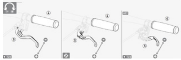
Figura 74: Ajustar el ancho de agarre de la palanca de freno con freno de disco Magura
