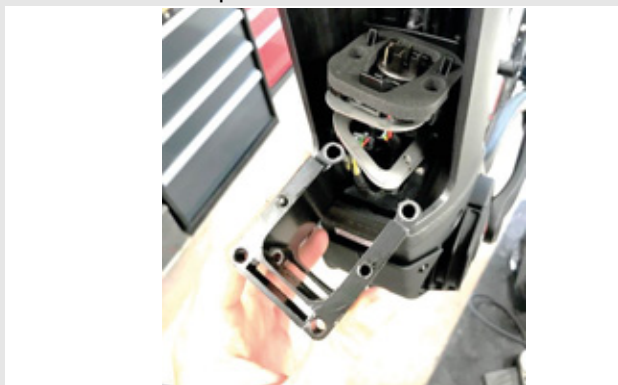
Figura 35: Extracción del adaptador PowerTube
