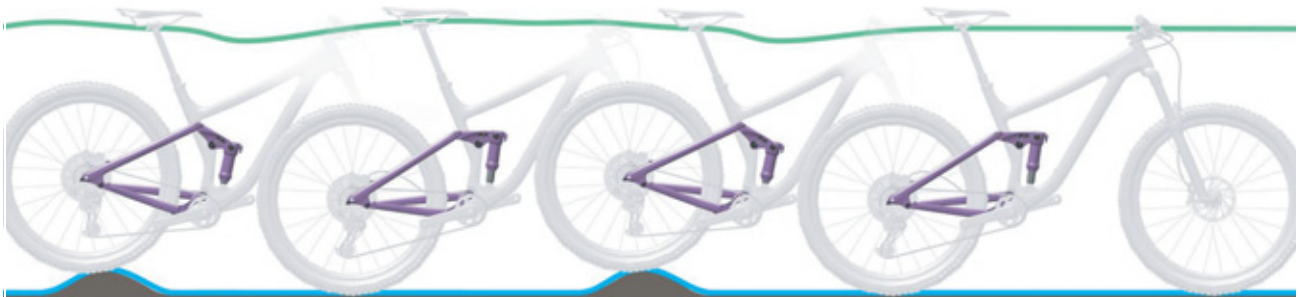
Figura 85: Condición óptima de marcha del amortiguador de la horquilla trasera
