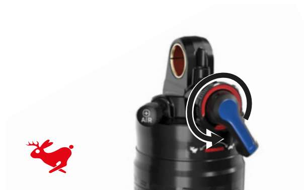
Figura 90: Incremento de la velocidad de descompresión
