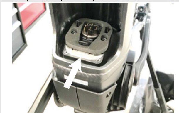
Figura 36: Placas adaptadoras montadas
