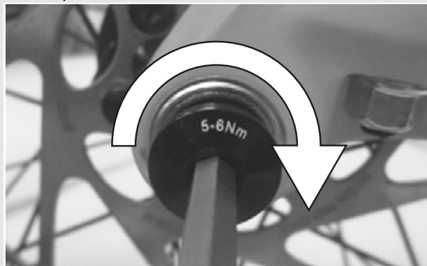
Figura 48: Apriete del tornillo de seguridad
