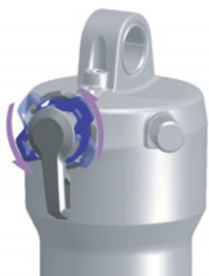
Figura 134: Ajuste para un regulador de niveles de presión más blando
