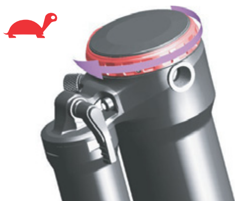
Figura 128: Giro del amortiguador de niveles de tracción en dirección a la tortuga
