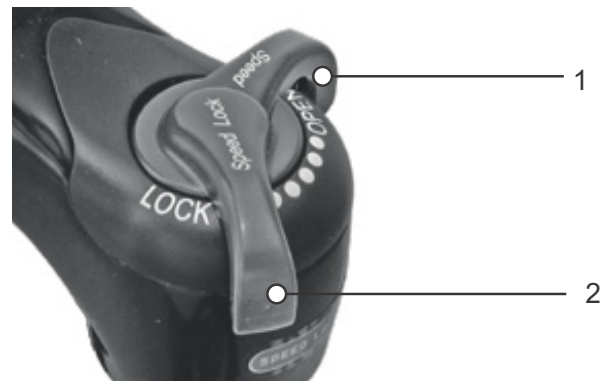
Figura 107: Amortiguador de niveles de presión Suntour en posición abierta (1) y cerrada (2)
