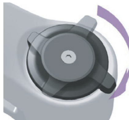
Figura 108: Ajuste para un regulador de niveles de presión más duro
