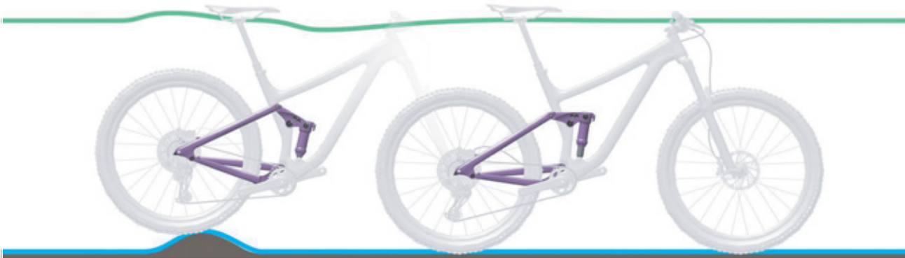
Figura 92: Condición óptima de marcha del amortiguador de la horquilla trasera en caso de irregularidades
