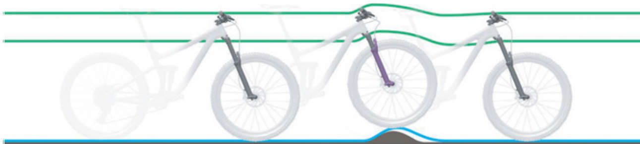
Figura 125: Amortiguación de la horquilla de suspensión demasiado dura en caso de irregularidades
