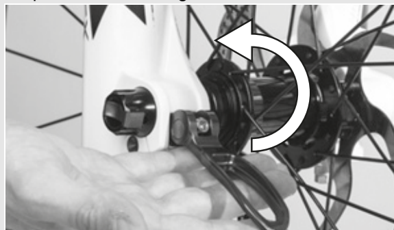
Figura 54: Seguridad de la palanca
