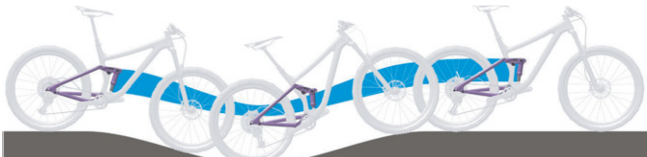
Figura 131: Suspensión del amortiguador de la horquilla trasera demasiado blanda en montaña
