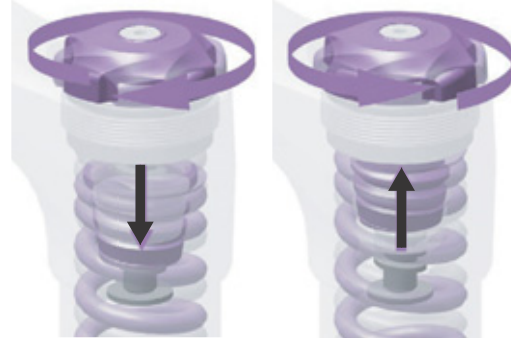
Figura 78: Enroscado y desenroscado del anillo de ajuste de la tensión previa
