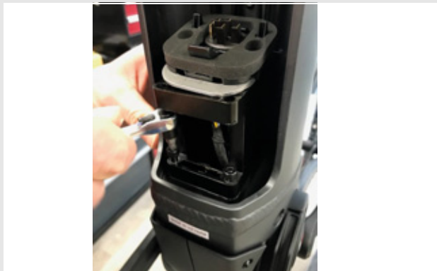
Figura 33: Retirada de los tornillos hexagonales de 4 mm
