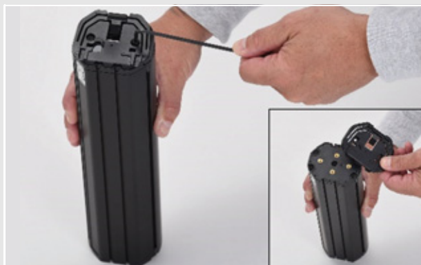
Figura 38: Desmontaje de la interfaz superior
