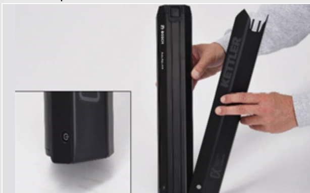
Figura 40: Desplazamiento de la cubierta de la batería sobre la batería
