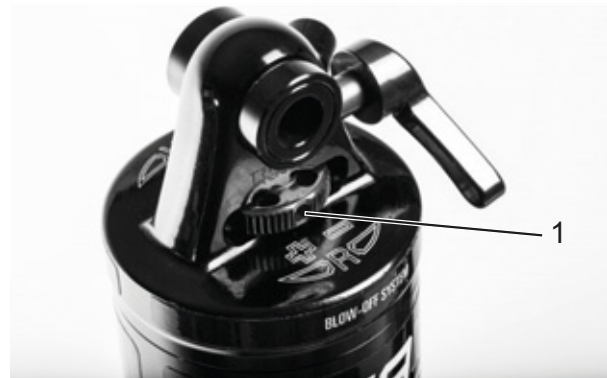
Figura 87: Rueda del regulador de niveles de tracción Suntour (1) en el amortiguador de la horquilla trasera
