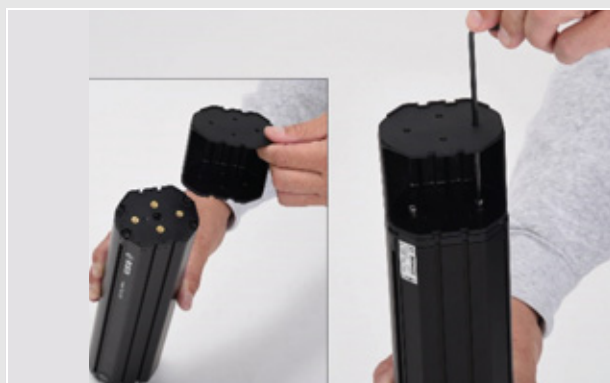
Figura 42: Montaje de la prolongación de la PowerTube
