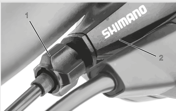
Figura 116: Casquillo de ajuste (1) del cambio de marchas accionado por cable de accionamiento con carcasa de la palanca de cambio (2), ejemplo
