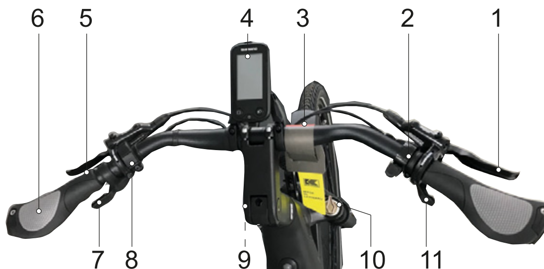
Afbeelding 28: Detailaanzicht stuur met Shimano SC-E5003 boordcomputer, voorbeeld
