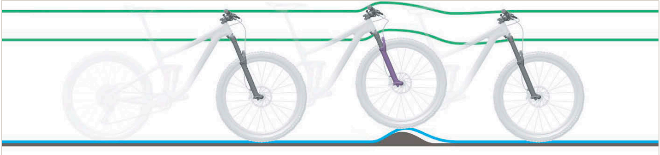
Illustration 275 : Amortissement trop dur de la fourche suspendue en cas d'irrégularités
