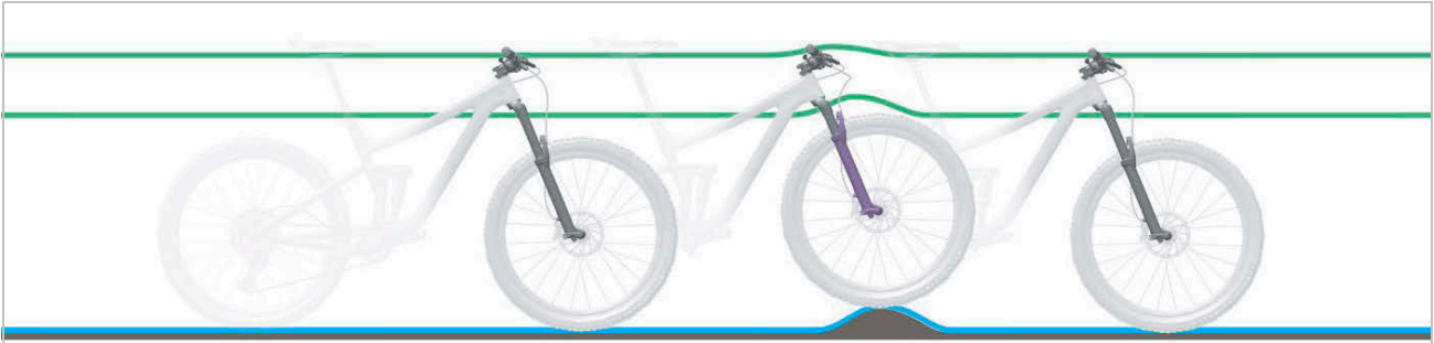
Illustration 20 : Comportement optimal de la fourche de suspension sur les irrégularités
