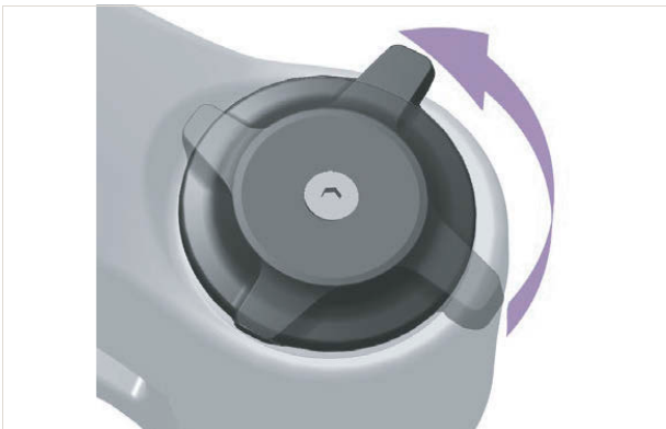
Illustration 276 : Régler le dispositif de réglage de la compression sur un niveau plus souple
