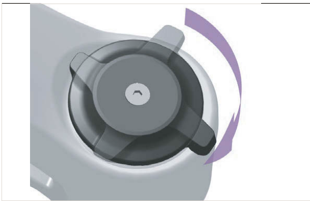
Illustration 274 : Régler le dispositif de réglage de la compression sur un niveau plus dur
