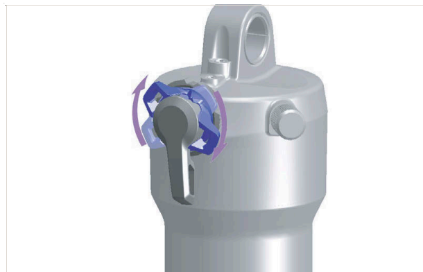
Illustration 199 : Régler le dispositif de réglage de la compression sur un niveau plus dur
