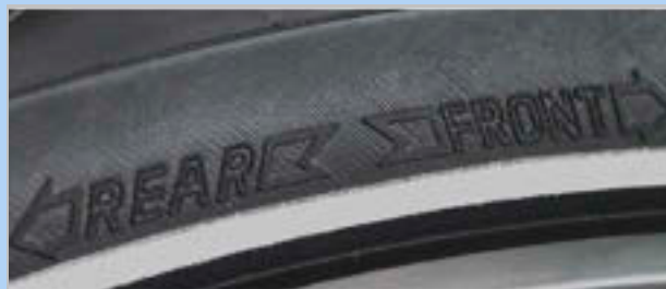
Illustration 98 : Flèche directionnelle sur les pneus VTT
