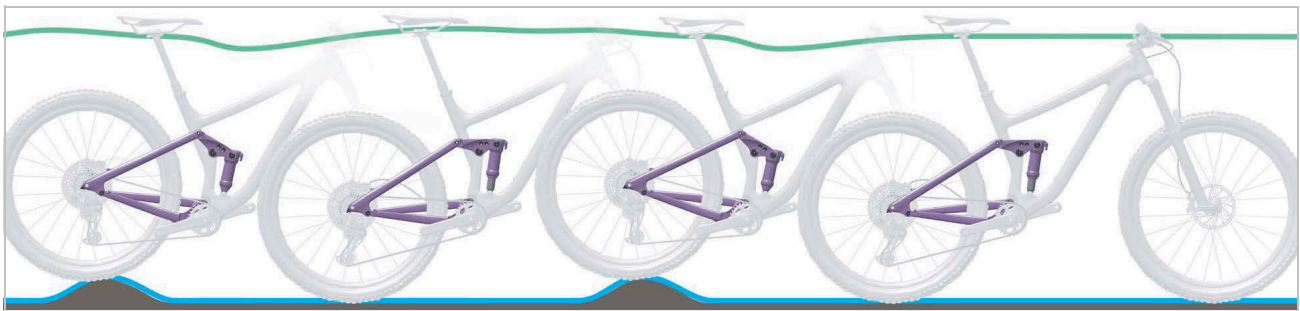
Illustration 6 : Comportement optimal de l'amortisseur arrière
