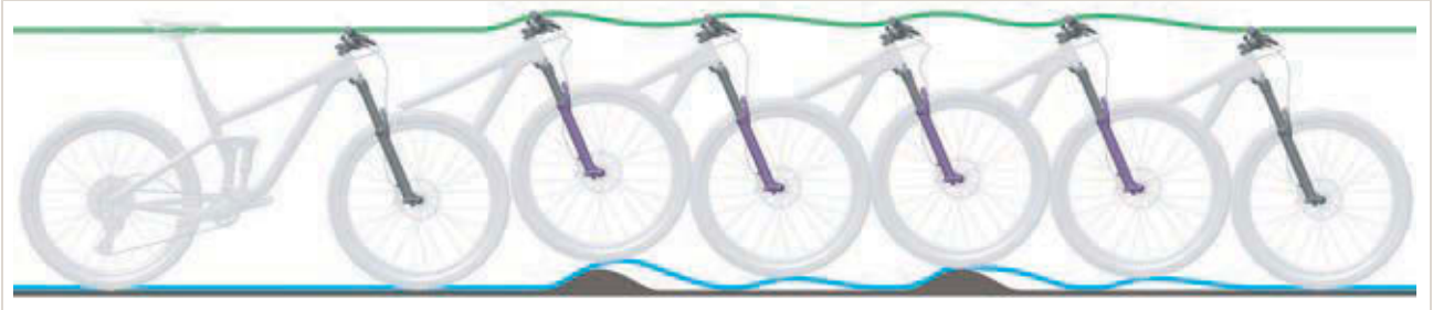
Illustration 269 : Détente trop rapide de la fourche suspendue
