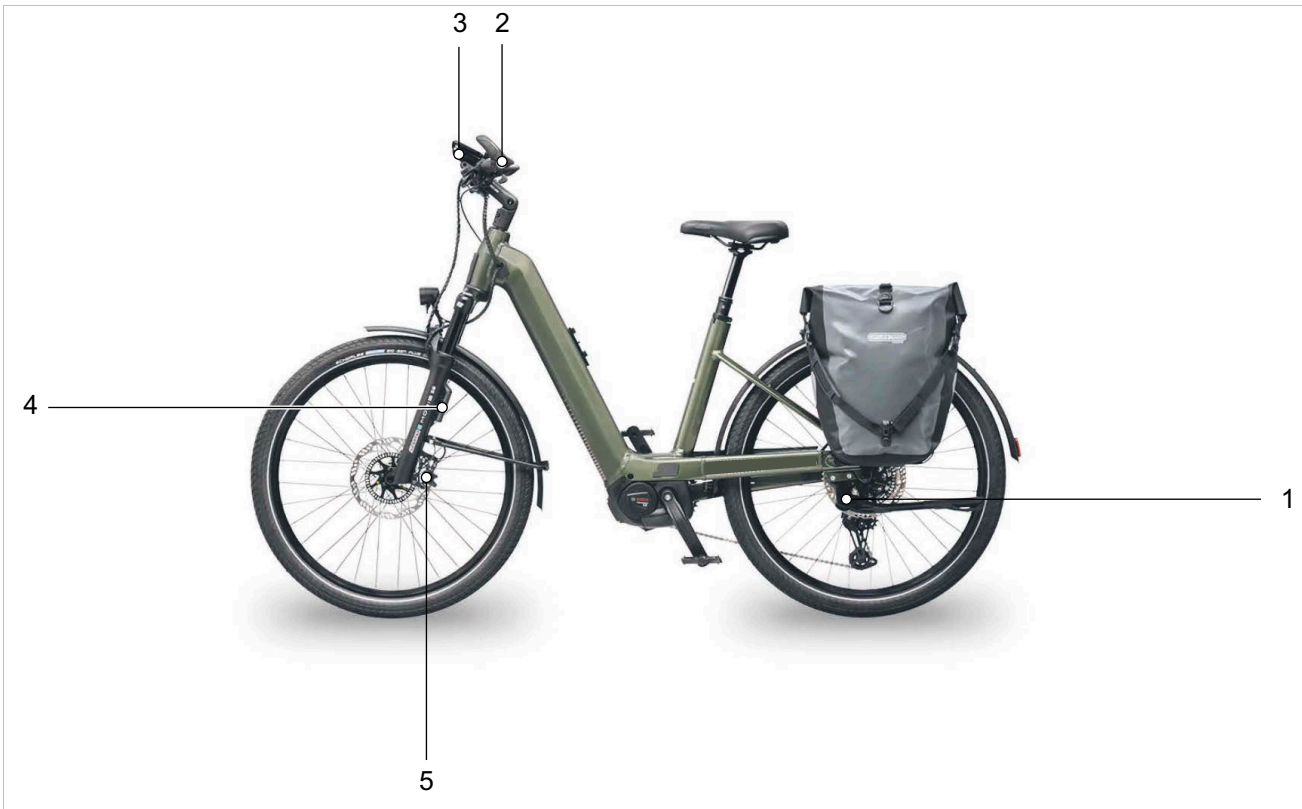
Illustration 44 : Composants de l'ABS BOSCH
