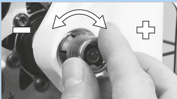
Illustration 111 : Régler la force de serrage
