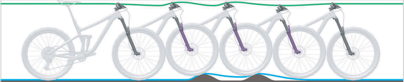
Illustration 265 : Détente trop lente de la fourche suspendue
