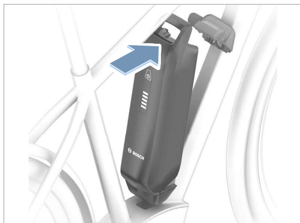
Illustration 187 : Rabattre la batterie PowerPack vers le haut
