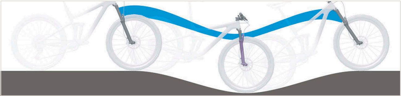
Illustration 273 : Suspension trop souple de la fourche suspendue dans les côtes
