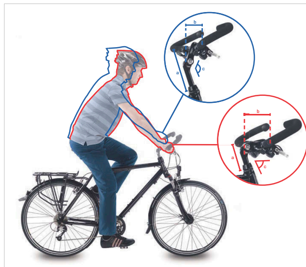
Illustration 137 : Position sur vélo de ville (en bleu) et sur vélo tout chemin (en rouge) avec modification de l'angle
