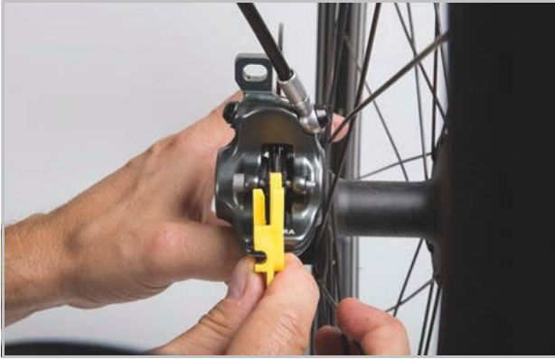
Illustration 231 : Contrôler la plaquette de frein montée à l'aide de la cale de transport
