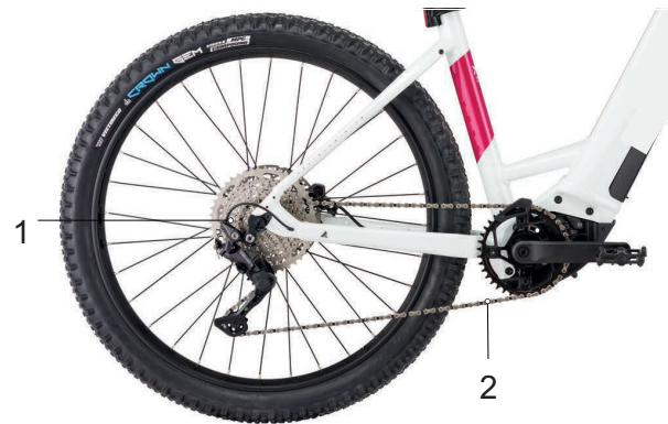
Afbeelding 44: Schema kettingaandrijving met derailleur
