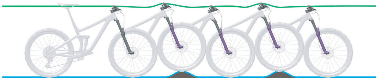
Afbeelding 131: Optimaal rijgedrag van de vork
