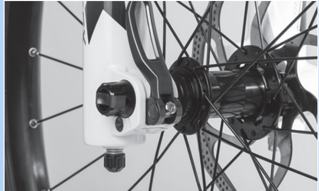
Afbeelding 215: Spankracht van de snelspanner afstellen
