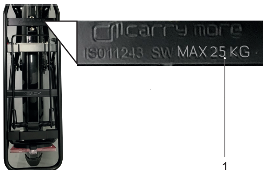
Afbeelding 159: Op de bagagedrager staat het maximale draagvermogen (1) vermeld
