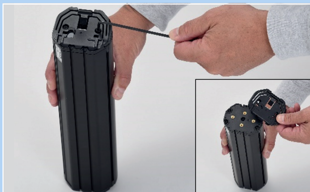
Afbeelding 72: Demontage bovenste interface
