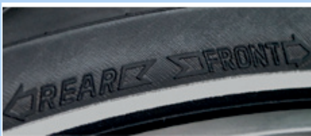
Afbeelding 95: Pijl draairichting op MTB-banden
