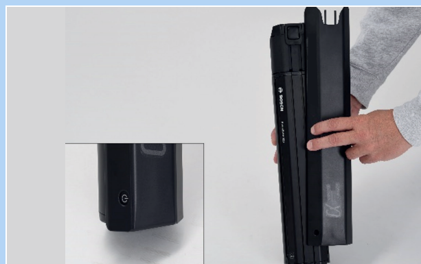
Afbeelding 78: Accuafdekking op de accu schuiven
