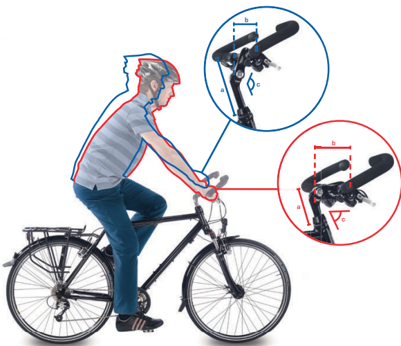
Afbeelding 121: Stadsfiets- (blauw) en toerfietsstand (rood) door verandering van de hoek
