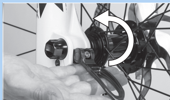
Afbeelding 87: Snelspanhendel in de richting van de pijl drukken
