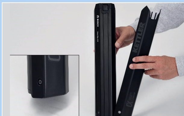
Afbeelding 74: Accuafdekking op de accu schuiven
