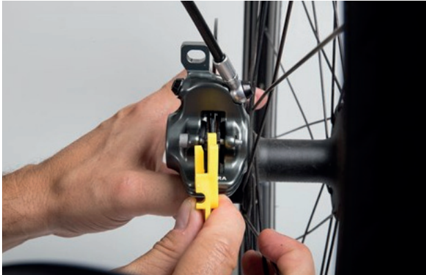
Afbeelding 187: Remvoering in gemonteerde toestand controleren met behulp van de transportbeveiliging
