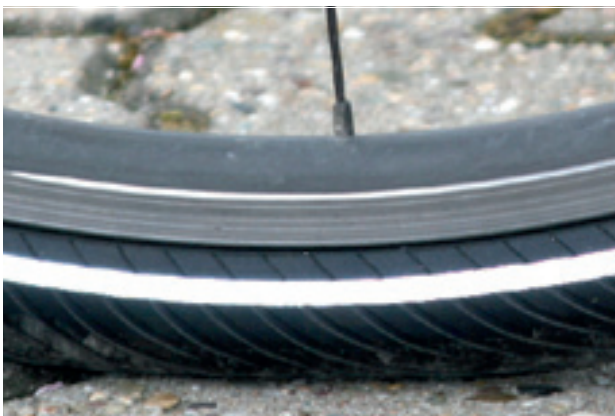
Afbeelding 123: Juiste vuldruk. De band is onder de belasting van het lichaamsgewicht nauwelijks vervormd
