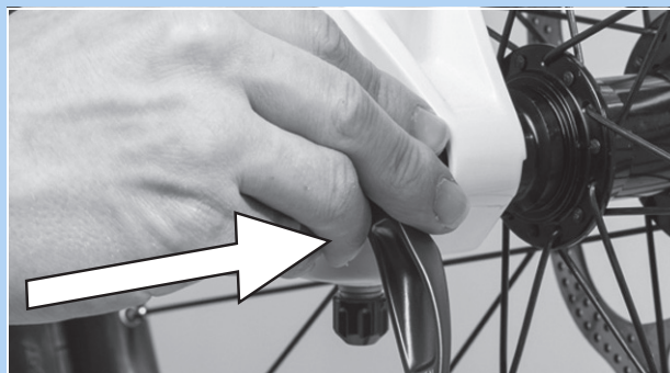
Afbeelding 91: Snelspanner in de richting van de pijl inschuiven
