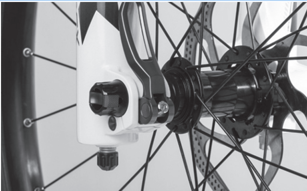
Afbeelding 88: Perfecte stand van de spanhendel
