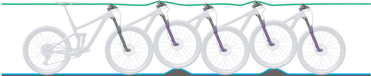
Afbeelding 12: Optimaal rijgedrag van de vork
