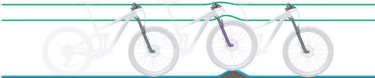
Afbeelding 133: Optimaal rijgedrag van de vork bij oneffenheden
