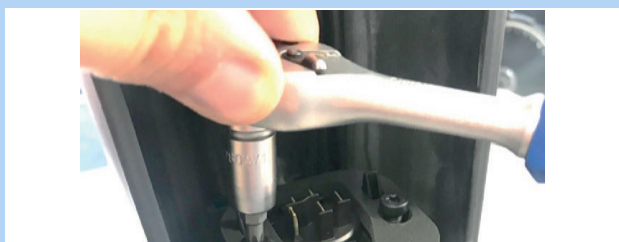
Afbeelding 66: Schroeven accuhouder losdraaien
