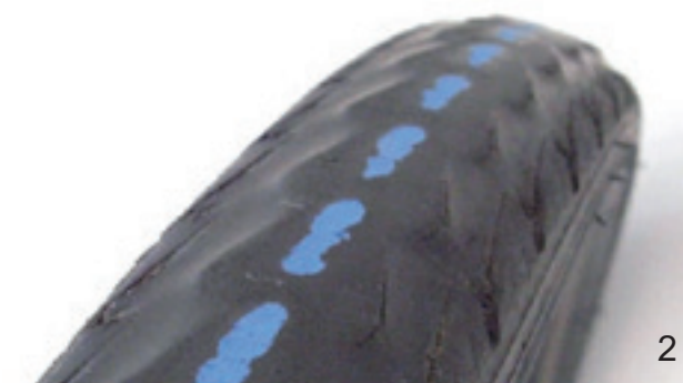
Afbeelding 185: Een band zonder profiel, die kan worden vervangen (1) en een band met zichtbare lekbescherming (2), die moet worden vervangen
