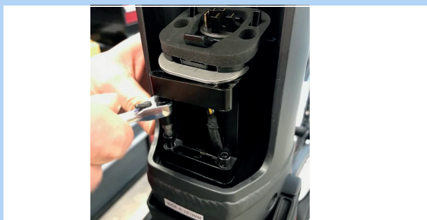
Afbeelding 67: 4 mm zeskantschroeven verwijderen
