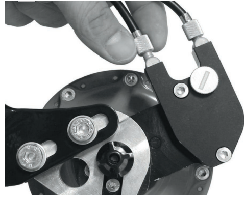
Afbeelding 212: Bij ROHLOFF naafversies met externe schakelaansturing zit de kabelafsteller op de kabelbox aan de linkerkzijde
