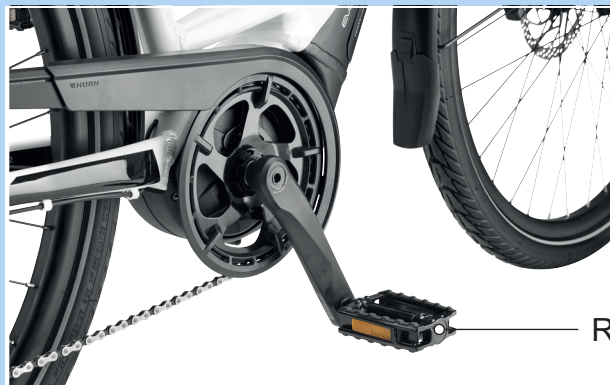
Afbeelding 98: R-pedaal in de rechter crankarm
