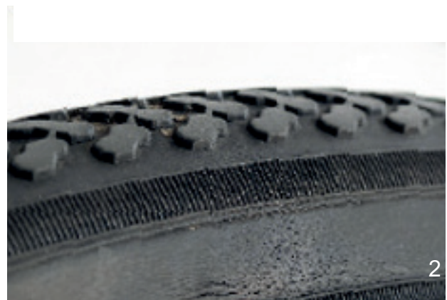
Afbeelding 186: Voorbeelden van vermoeiingsscheuren (1) en verouderingsscheuren (2)
