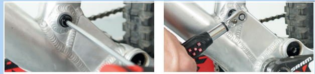
Abbildung 229: Postpin Achse befestigen
