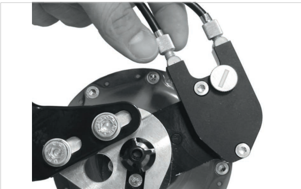
Abbildung 193: ROHLOFF-Naben Versionen mit externer Schaltansteuerung haben die Zugeinsteller an der Seilbox, die sich auf der linken Seite befindet
