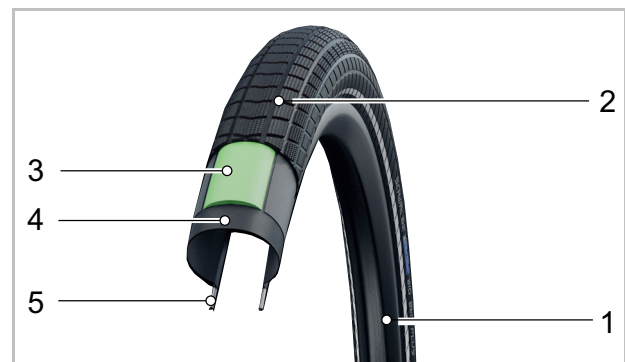
Abbildung 23: Aufbau offener Reifen
