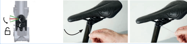
Abbildung 199: Höhenverstellungsbetätigung in „Geöffnete Stellung“ bringen
