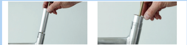
Abbildung 230: Gleitbuchsenrohr ins Sattelrohr stecken
