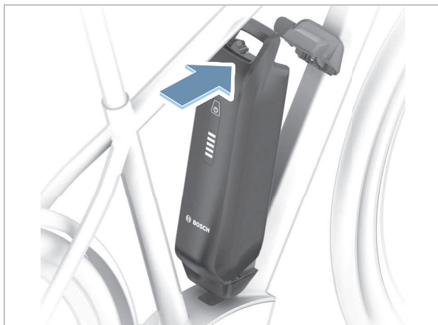
Abbildung 137: PowerPack Akku nach oben klappen
