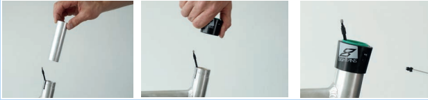
Abbildung 256: Gleitbuchse und Außenhülse einbauen
