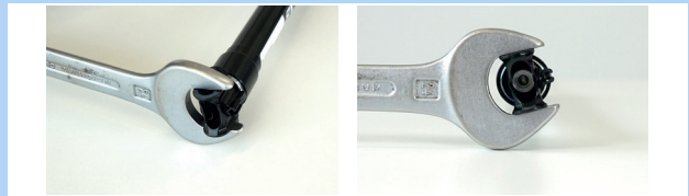
Abbildung 220: Gegen Verdrehen sichern
