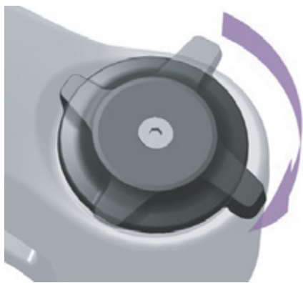
Afbeelding 207: Drukdemperafsteller harder afstellen
