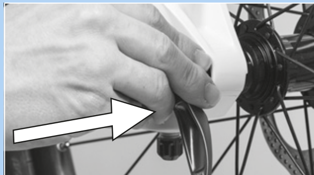
Afbeelding 54: Snelspanner in de richting van de pijl inschuiven
