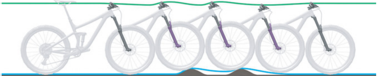
Afbeelding 204: Te langzaam uitveren van de verende voorvork
