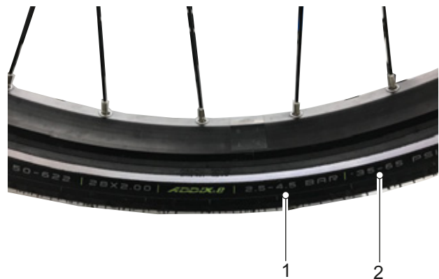
Afbeelding 118: Vuldruk in bar (1) en psi (2)
