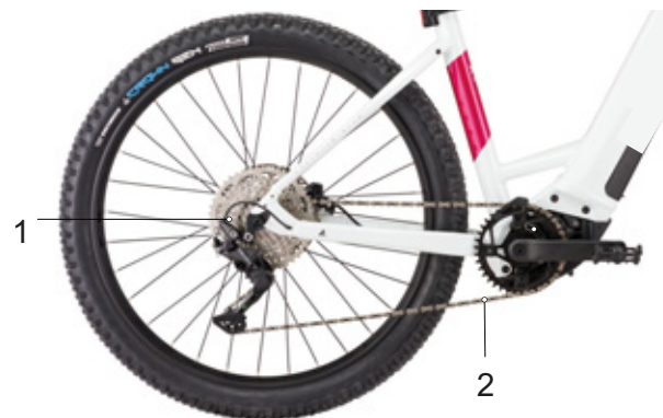
Afbeelding 25: Schema kettingaandrijving met derailleur
