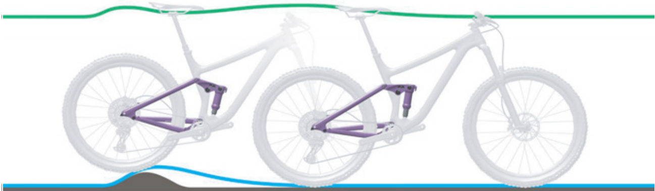
Afbeelding 216: Te harde demping van de achterbouwdemper bij oneffenheden
