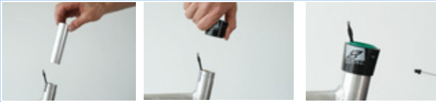
Afbeelding 156: Glijbus en buitenhuls monteren
