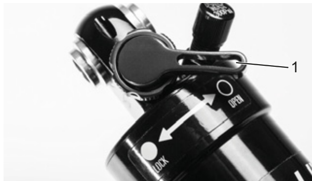
Illustration 77 : Dispositif de réglage de la compression Suntour ouvert (1)
