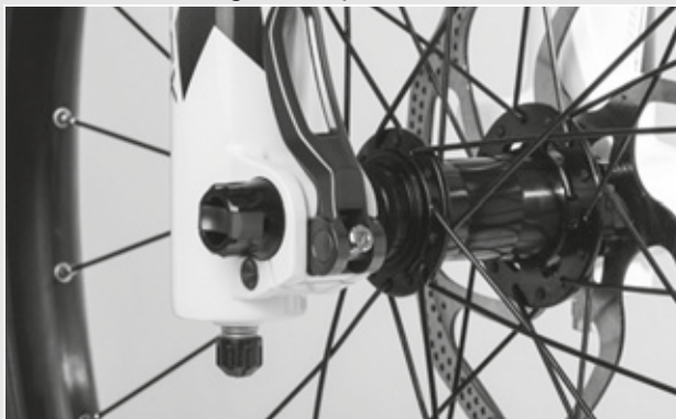
Illustration 35 : Position parfaite du levier de serrage
